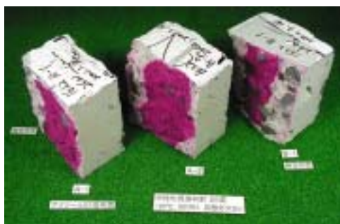
中性化促進試験後の角柱供試体
