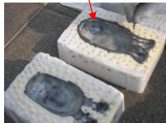
型に塗布した樹脂が半硬化または硬化後接着用として縁にPUR11を塗布します。
